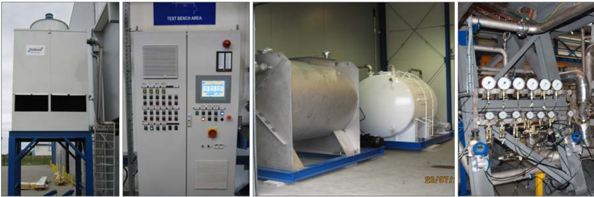
Fot. 4. Elementy stanowiska prób: chłodnia wentylatorowa, panel sterowania, zbiorniki wody i paliwa, panel instrumentów
